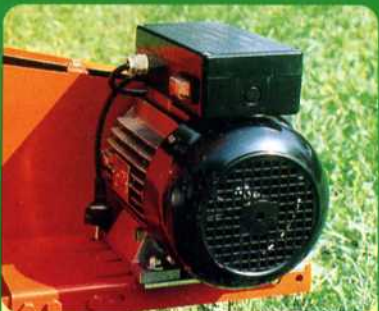
MOTORE ELETTRICO 3 E CV - 220 / 380 V
